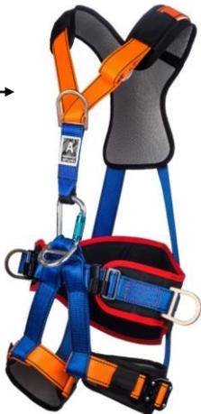
Arnés MIRA 20A con cinturón incorporado, 2 puntos de enganche anticaídas, 2 puntos de enganche de sujeción y 1 punto de enganche de suspensión. Regulación en hombreras y cinturón, perneras regulables mediante **hebillas de cierre automático**. Con **acolchados de confort** desmontables en hombreras y perneras. Con bolsa porta-equipos.
