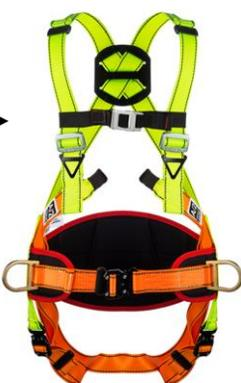
Arnés anticaídas MIRA 18A con cinturón de sujeción integral. Con 2 puntos de enganche anticaídas, uno dorsal y otro pectoral y 2 enganches de sujeción. Hombreras regulables. Perneras y cinturón regulables mediante **hebillas de cierre automático**, broche pectoral metálico. Triángulos de PVC para depositar amarres. Con bolsa porta-equipos.
